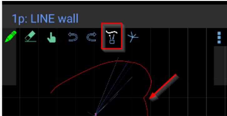
Slika 52. Dugim pritiskom na ikonu palete aktivira se automatsko spajanje linija
