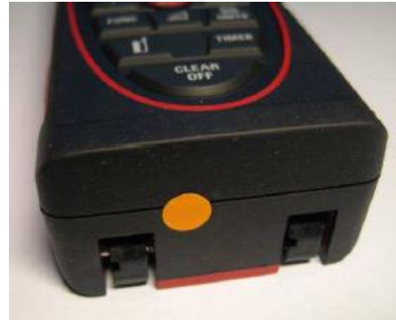
Slika 19. Izlazna točka laserske zrake
