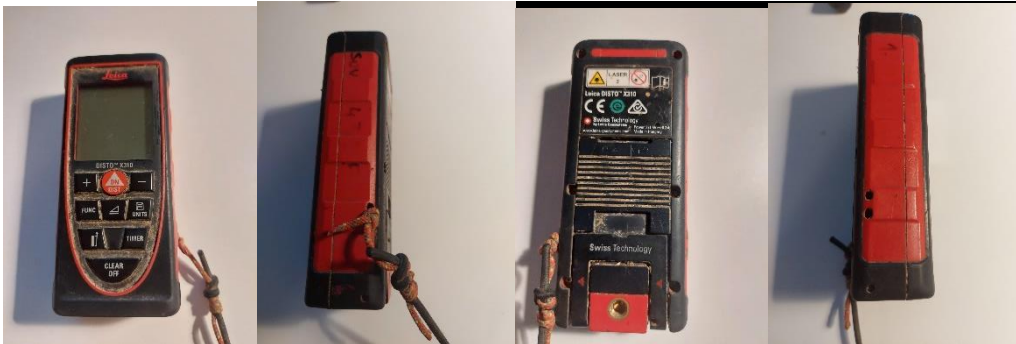
Slika 37. Četiri orijentacije DistoX2 uređaja
