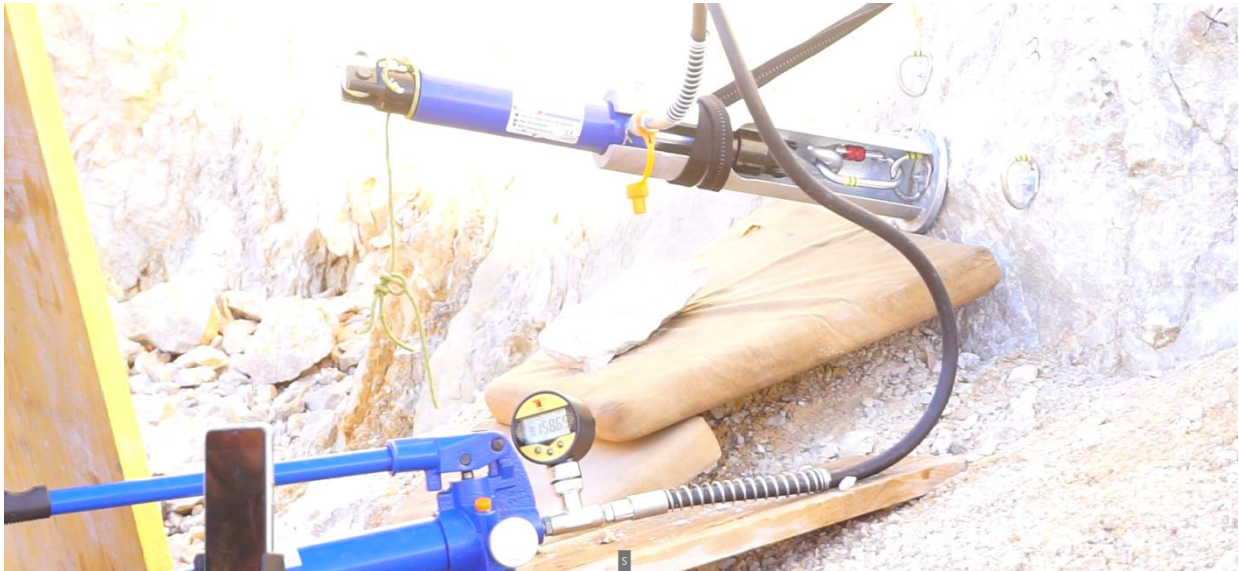
Fotografija 3. Testiranje sidrenog vijka na vlačno opterećenje (Goran Jerković)
