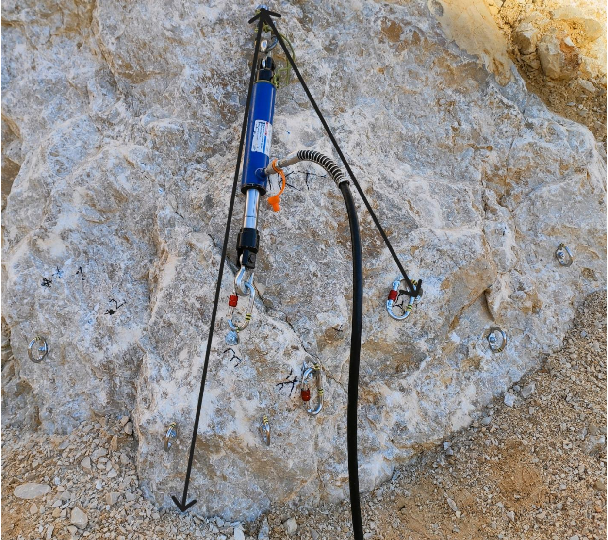
Fotografija 2. Princip testiranja s kidalicom (Goran Jerković)
