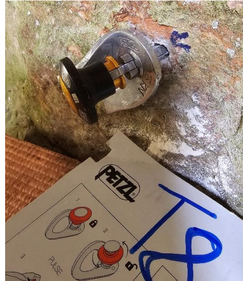
Fotografija 13. Test T8: Mobilno sidrište ostalo u stijeni prilikom smicanja. Autorica: Anita Trojanović
