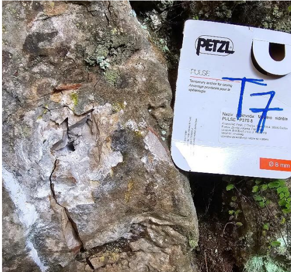
Fotografija 12. Test T7: Izgled raspuknute stijene nakon smicanja mobilnog sidrišta. Autorica: Anita Trojanović
