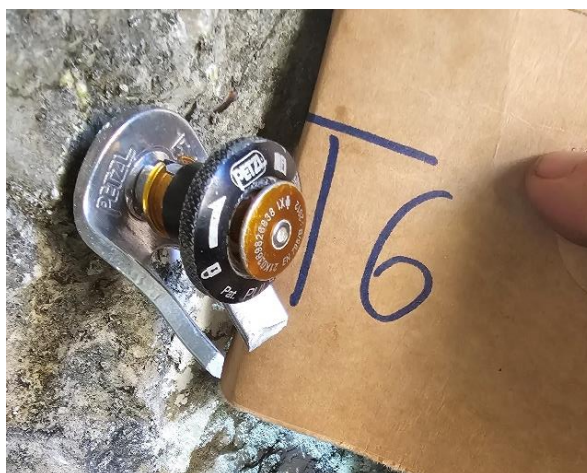
Fotografija 17. Test T6: Izgled mobilnog sidrišta nakon vlačnog napreznja na stijeni. Autorica: Anita Trojanović
