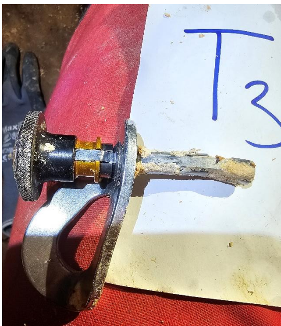
Fotografija 10. Test T3: Izgled mobilnog sidrišta nakon smicanja na sigovini. Autorica: Anita Trojanović
