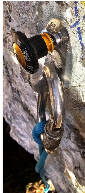
Fotografija 20. Test T10: Ispravno opterećeno mobilno sidrište nakon testiranja na pad. Autorica: Anita Trojanović
