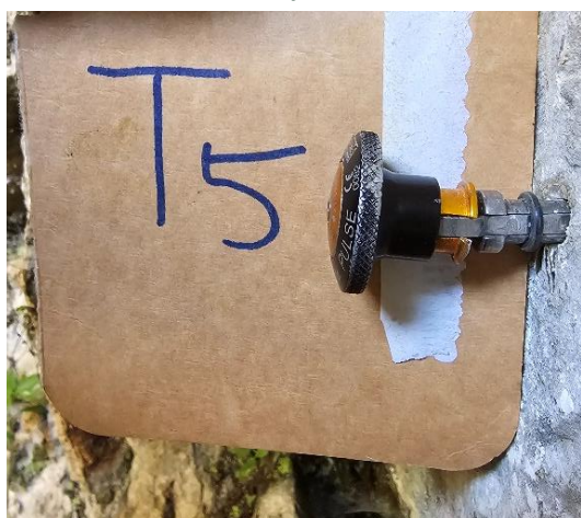
Fotografija 16. Test T5: Izgled mobilnog sidrišta nakon vlačnog napreznja na stijeni. Autorica: Anita Trojanović
