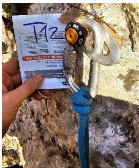
Fotografija 22. Test T12: Neispravno opterećeno mobilno sidrište nakon testiranja na pad. Autorica: Anita Trojanović
