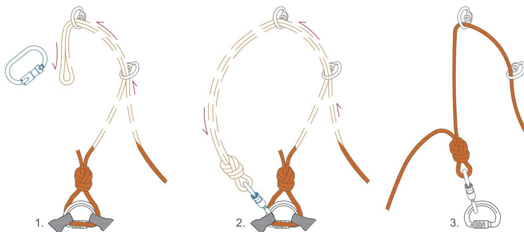
Ilustracija 14. Provlačenje osiguravajućeg užeta kroz ring-ove i izrada uzla. Autorica: Anita Trojanović
