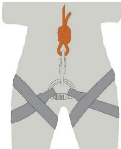
Ilustracija 13. Osiguranje penjača dinamičkim užetom prilikom absail -a. Autorica: Anita Trojanović
