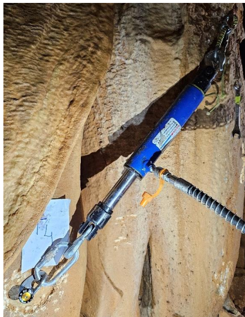
Fotografija 11. Test T4: Položaj kidalice i mobilnog sidrišta prilikom smicanja na sigovini. Autorica: Anita Trojanović
